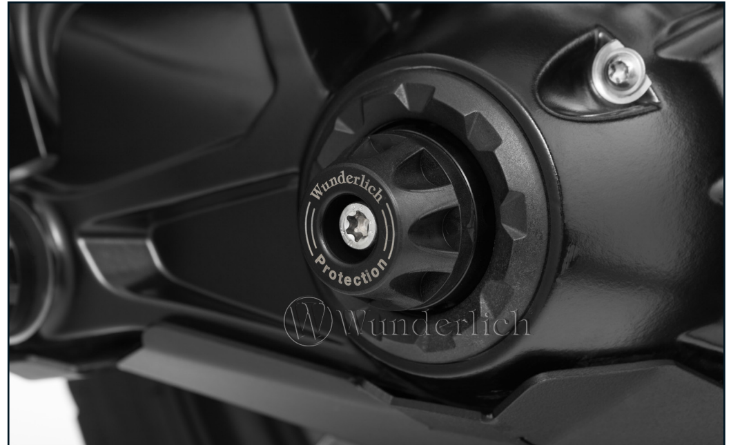
Nabenabdeckung bis zum Anschlag einschieben (Gummi Hammer)! Push in the hub cover until it stops (rubber mallet)!
