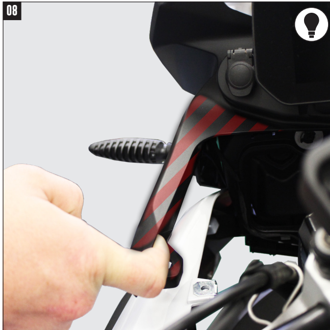
08 Drücken Sie die Verkleidung bei Seite um den Halter montieren zu können. Press the panel aside to mount the bracket.
