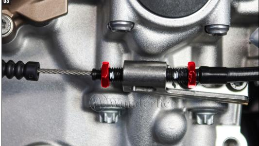
**EINSTELLUNG MARKIEREN UND LÖSEN.** *Mark setting and loosen. Marquer le réglage et le desserrer.*
