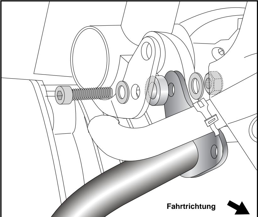
Befestigung des Motorschutzbügels hinten
