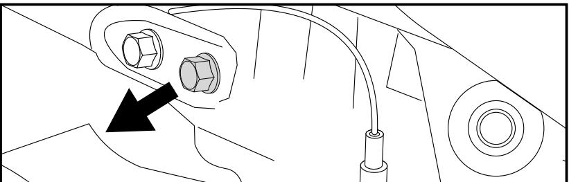
Befestigung des Motorschutzbügels vorne
