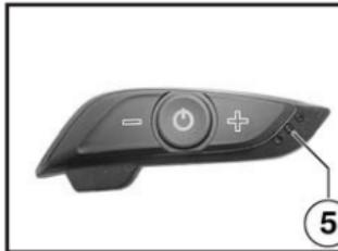
Желтый светодиод 5 будет гореть постоянно в течение процесса заряда. По окончании процесса заряда элемента питания желтый светодиод погаснет, а контроллер элемента питания переключится в режим поддерживаемого заряда.
